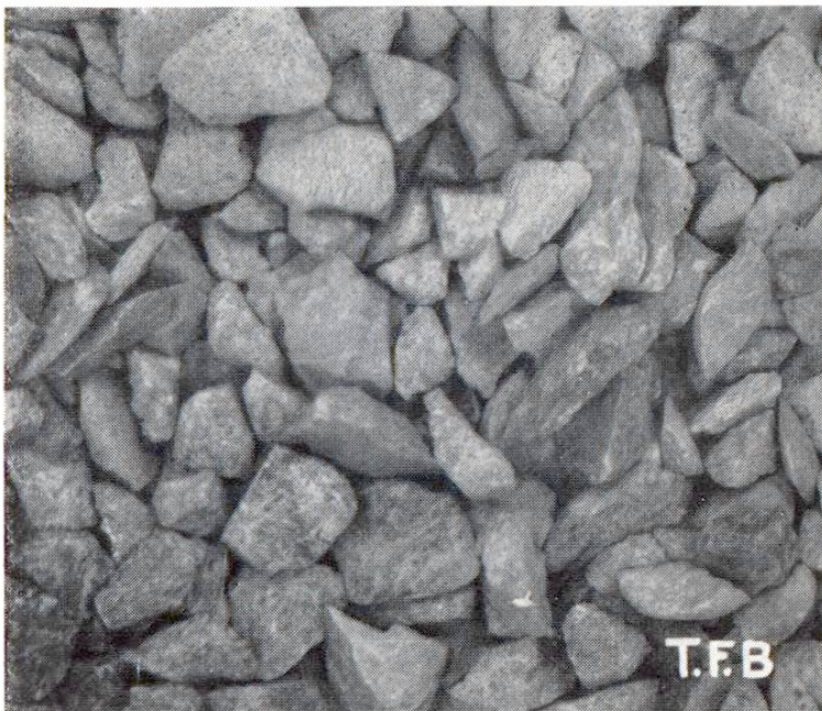
Fig. 2 Gravier concassé pour béton, obtenu par réduction de fractions excédantes de matériaux grossiers extraits du sol
