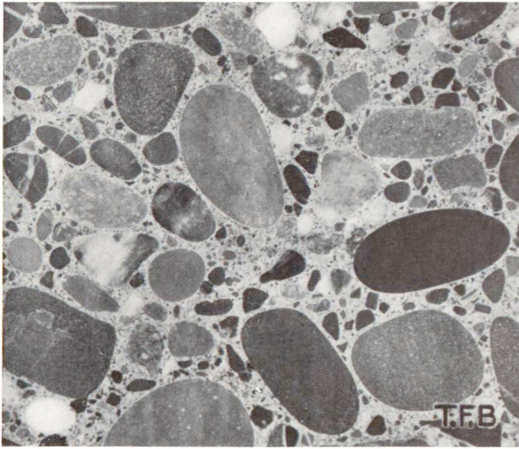
Fig. 3 Coupe à travers un béton de qualité très compact fabriqué avec des agrégats naturels
