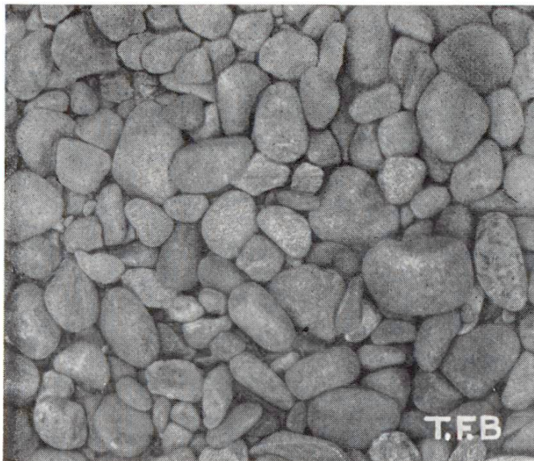
Fig.1 Gravier naturel pour béton provenant de bancs morainiques de l'époque glaciaire
