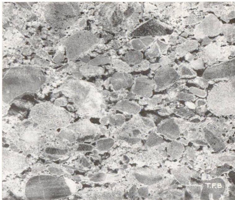
Fig. 5 Une coupe à travers le béton présente une concentration locale de gravier, provoquant des nids de gravier (pores ouverts, c'est à dire communicants)
