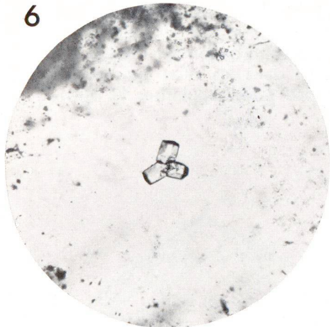
Fig. 7 Cristal triple d'hydrate de chaux nouvelle combinaison résultant de la décomposition de l'alite pendant la prise (agrandissement 50 x)
