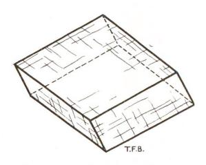
Fig. 3 Cristal idéal de calcite (carbonate de calcium), constituant important des matières premières du ciment
