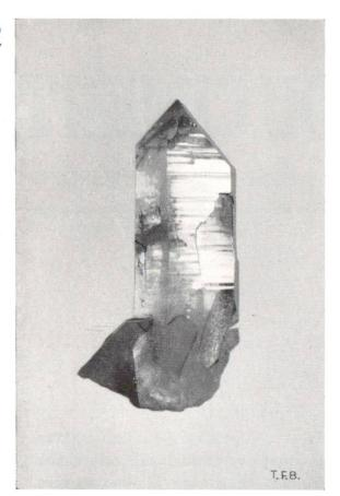
Fig. 1 Le quartz (cristal de roche) est techniquement de la silice pure. Celle-ci est un des principaux constituants élémentaires du ciment qui en contient environ 1/5 ème de son poids
