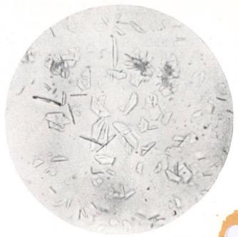
Fig. 8 Cristaux d'hydrate de chaux et d'alumine résultant de la décomposition de l'aluminate tricalcique pendant la prise (agrandissement 300 x)
