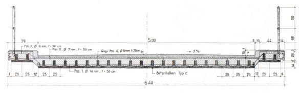
Fig. 5 Détail de la coupe transversale d'un pont. Exemple de l'emploi d'éléments précontraints comme armature (Neue Granito Bau AG., Zurich)
