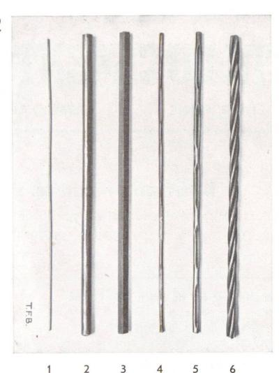
Armatures en acier pour béton précontraint
