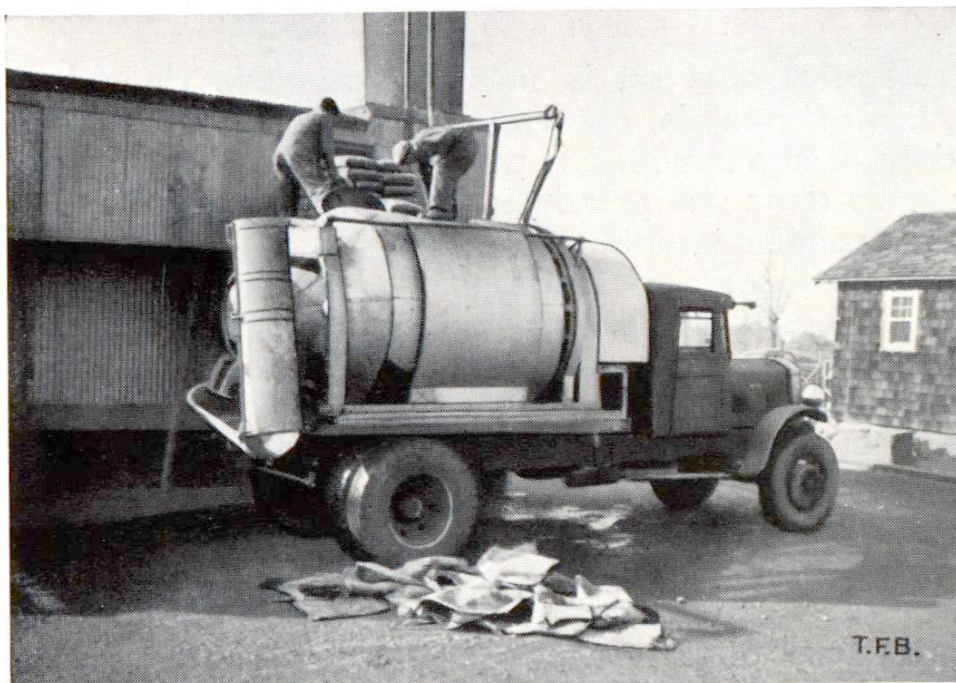
Fig. 6 Camion-malaxeur de 3m 3 . Le ciment est ajouté après l'introduction du sable et du gravier, puis l'eau est versée dans le malaxeur obturé. Celui-ci est actionné peu avant d'atteindre le chantier
