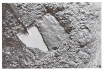
Ce mélange contient trop de sable et d'eau. Quoiqu'il soit très maniable, ce béton n'aura ni grandes résistances, ni bonne compacité (imperméabilité)
