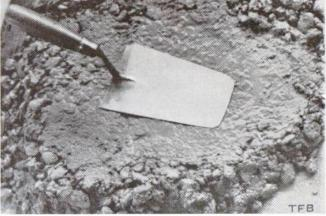
Ce béton est bon! Tous les composants y sont réunis dans le rapport le plus favorable et la consistance est telle que le béton ne devient plastique (pâteux) que lors de la mise en œuvre. Lorsque l'on égalise le béton à la truelle, il se forme une surface unie et lisse
