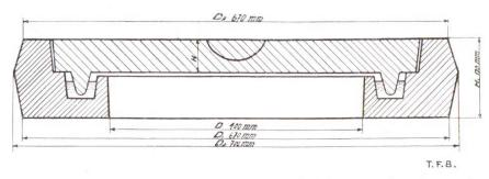
Fig. 3 Couvercle en béton avec dispositif d'étanchéité contre les émanations gazeuses (brevet annoncé)
