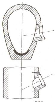
Fig. 2 Tuyau de canalisation, profil en œuf, avec revêtement partiel en grès céramique et manchon de raccordement
