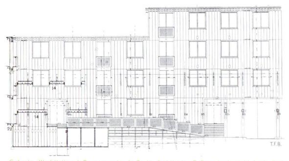
Colonie d'habitation à Drancy, près de Paris. Architectes E. Beaudouin et M. Lods, Paris. Eléments standardisés en béton armé, fabriqués en série, pour les parois extérieures, planchers, balcons, parapets, cadres de fenêtre
