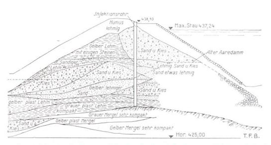
Fig. 4 Etanchéification de digue par injection de ciment. Section caractéristique de la digue (de la revue polytechnique suisse 1931, No. 11, voir bibl.)
