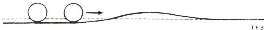
Fig. 1 Représentation schématique de l'oscillation précédant le convoi roulant. Sous le train, le berceau de la voie se tasse tandis que devant lui la superstructure se soulève légèrement comme la vague provoquée par un caillou que l'on jette dans l'eau.
