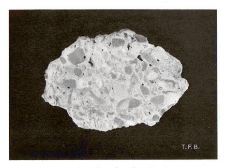
Fig. 2 Béton romain d'un aqueduc à Avenches (Aventicum)
