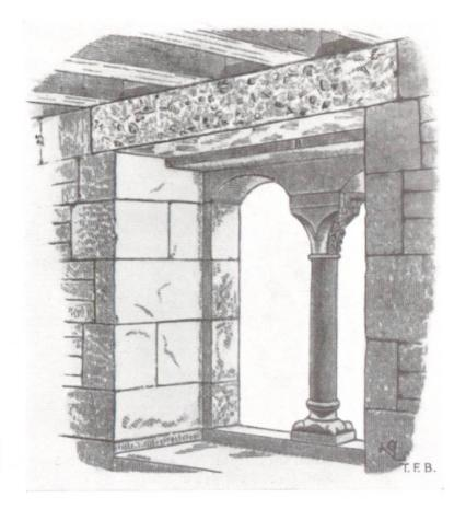
Fig. 5 Linteau en béton du château de Carcassonne (Midi de la France), Dimensions 1,20 x 0,30 x 0,20 m.
