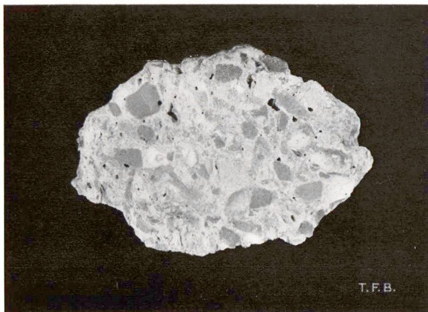
Fig. 2 Béton romain d'un aqueduc à Avenches (Aventicum)
