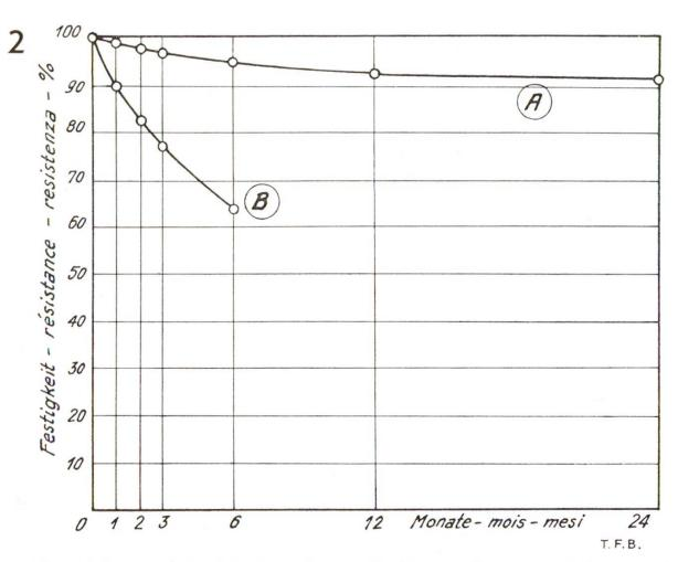
Fig. 1 Influence de la durée de stockage sur la résistance d'un ciment. A Entreposage très soigné. B Conditions défavorables de conservation
