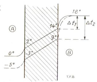
Ligne de température à travers une paroi extérieure. A = dehors, B = dedans. On remarquera les différences de température entre la surface de la paroi et l'air ambiant. Pour  $\triangle$   $t_1$  une humidité relative de 75 % de l'air ambiant, il n'y a pas encore de condensation tandis que pour  $\triangle$   $t_2$  la condensation se produit déjà par atmosphère sèche (humidité relative 60 %)
