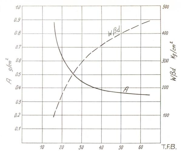
Fig. 1. A = usure en g/cm², W  $\beta$  d = résistance à l'écrasement du cube. Essai d'usure appliqué à des bétons de différentes résistances. Avec un même matériau d'apport, l'usure est en général d'autant plus petite que la résistance à l'écrasement est plus grande
