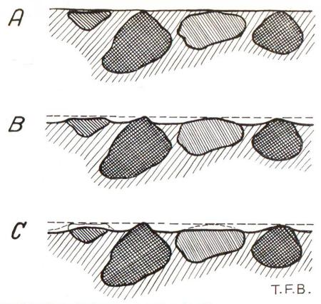
Fig. 3 Représentation schématique de l'usure progressive du béton: A = Béton frais
