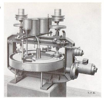
Dispositif pour l'essai d'usure de roches et bétons. 2 éprouvettes de revêtement sont maintenues simultanément en frottement, sous pression constante, avec la plaque de la machine. Après 100, 200 tours, ou plus, on détermine la perte de poids des éprouvettes
