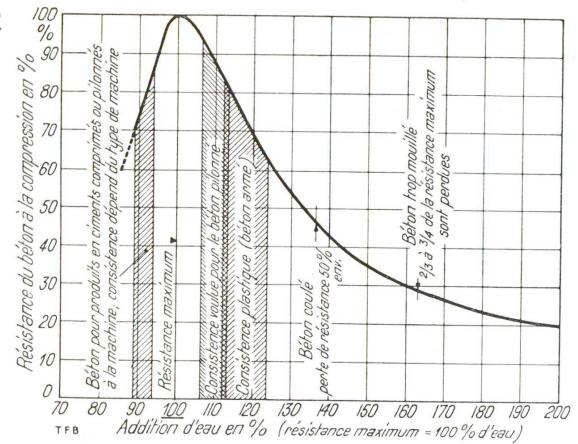
Fig. 1 Influence de la quantité d'eau de gâchage sur les résistances à la compression du béton
