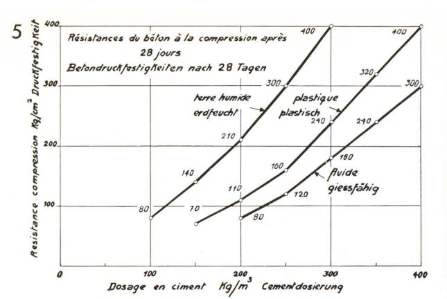
Fig. 4 Influence du dosage et de la consistance sur les résistances à la compression du béton
