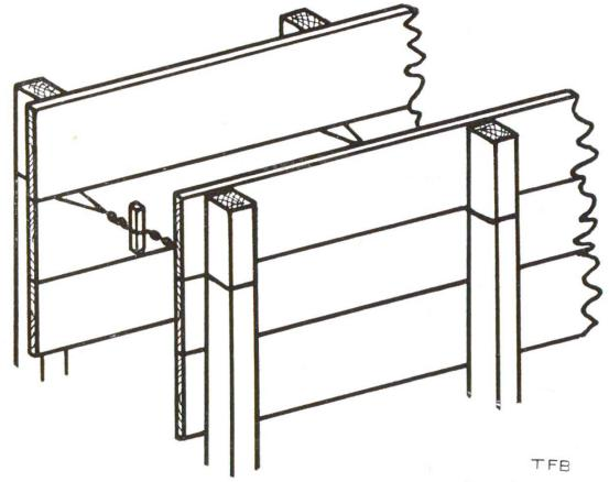
Fig. 1 Les parois intérieures et extérieures du coffrage sont reliées entre elles par des fils de fer jumelés et tordus qui absorbent la poussée latérale du béton encore mou. Lorsque les pressions sont grandes, on remplace les fils de fer par des barres filetées entourées de papier.
