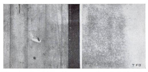
Fig. 4 A gauche, surface de béton obtenue avec un coffrage raboté, à droite le même béton, mais avec un coffrage garni de bois contreplaqué imprégné.
