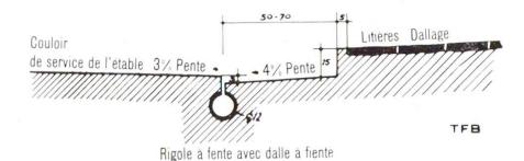
circuler que de faibles quantités d'excréments. L'urine s'écoule ainsi plus rapidement au dehors du local réchauffé et n'entre en fermentation que dans la fosse. La fig. 1 montre une bonne disposition de la dalle à fiente et du couloir de service de l'étable.
