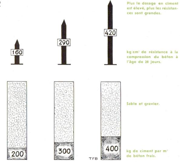
Il faut autant que possible utiliser un sable lavé à grains arrondis. Le sable ne doit pas contenir plus de 15 % de grains inférieurs à 0,2 mm (tamis de 900 mailles). On prendra l'habitude de contrôler souvent cette proportion. Un béton à teneur élevée en sable fin devient spongieux, perméable, gélif et sa résistance mécanique n'est jamais très élevée. Le sable fin est appelé avec raison «dévoreur de ciment».
