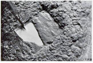
Ce mélange contient trop de sable et d'eau. Quoiqu'il soit très maniable, ce béton n'aura ni grandes résistances, ni bonne compacité (imperméabilité).
