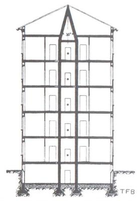
Fig. 3 Construction à armature de béton avec abris, résistant aux coups directs, pour chaque étage.
