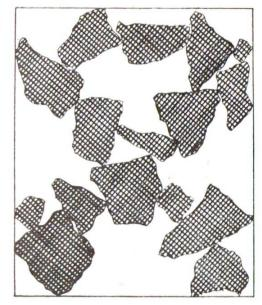
Structure de la farine de ciment Analogie avec la neige poudreuse; agglomération en forme de voûte. Poids spécifique du ciment: 3,1 kilo/ litre. Densité apparente du ciment 1,2 kg/dm³, ce qui représente plus de 60 % de vides d'air.
