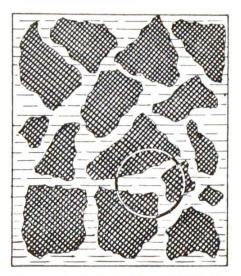
Structure de la pâte fraîche de ciment. L'eau fonctionne comme un lubrifiant et entoure les grains de ciment d'un film. Densité de la pâte de ciment: 2,1 kg/dm³.
