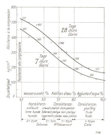
Fig. 2. Influence de l'addition d'eau sur la résistance du béton à la compression et variation de l'affaissement en fonction de la quantité d'eau de gâchage.
