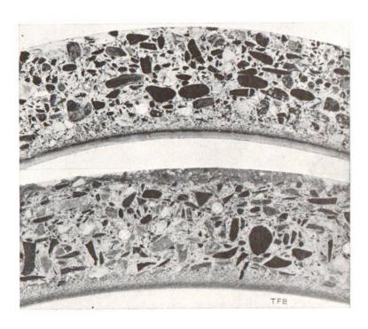
Fig. 3 Structure du béton centrifugé.
