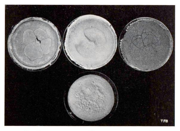
bleu clair fortes efflorescences vert-bleu fortes efflorescences jaune sans efflorescence violet faibles efflorescences
