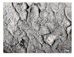
Fig. 1 Défectuosité d'une peinture à l'huile, appliquée sur une surface de béton à réaction alcaline — on a omis de traiter la surface de béton avant de la peindre.
