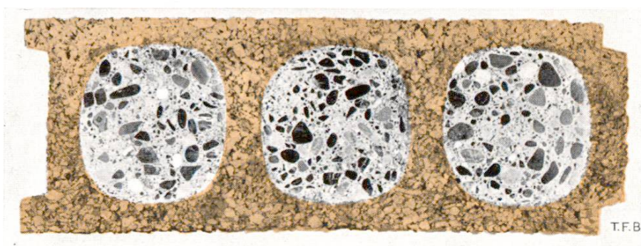
Fig. 1 Section d'une paroi en béton-liège Coefficient de passage thermique k = 0,65
