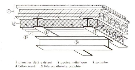
Fig. 3 Renforcement d'une dalle à corps creux au moyen de poutres métalliques et de béton armé.
