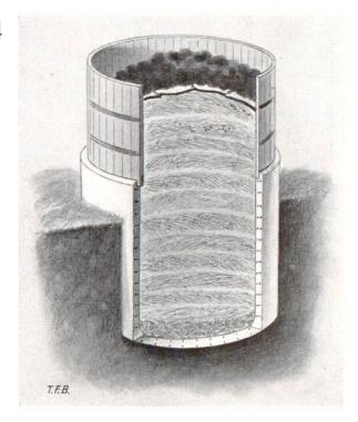
Fig. 2 Silo à fourrage vert de forme cylindrique, en béton armé et surmonté de sa cage en bois.
