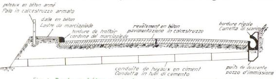
Fig. 1 Route en béton munie de produits modernes en ciment. T.E.
