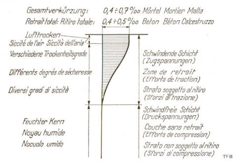
Fig. 1 Représentation schématique du retrait d'un élément en béton pendant le dessèchement à l'air.
