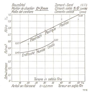
Fig. 2 Retrait d'une série de mortiers 1:6 (poids) en fonction de la teneur en sable fin et de la consistance (d'après Graf, Stuttgart).
