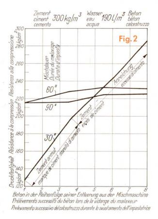
no. 1 au moyen des 10 premiers litres de béton expulsés du tambour, au moyen des 10 litres suivants on a fabriqué l'éprouvette no. 2, etc. . .
