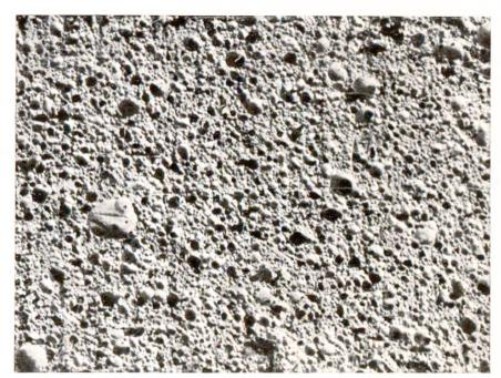
Fig. 2. Structure du béton cellulaire. arossi 2 fois
