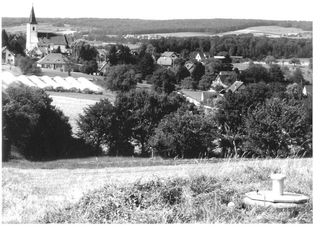
Abb. 5: Blick vom Oberfeld auf das Dorf. Im Vordergrund rechts die Brunnstube, in die drei Quellbäche des Birsigs münden. Das Wasser fliesst weiter in das Reservoir an der Rue du moulin und dient der Wasserversorgung des Dorfes. Nur der Überlauf der Brunnstube fliesst in den Birsigraben bzw. in den Birsig. (Foto Verfasser)
