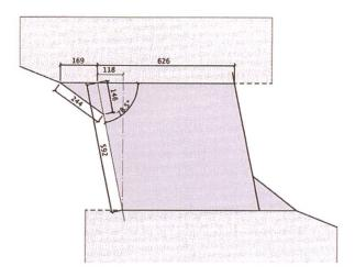
Abb. 5.3: Konstruktionsschema der Bütschenbrücke, Aufsicht.
