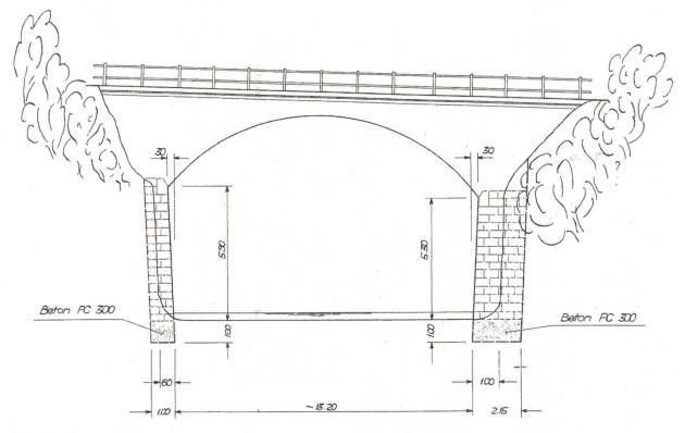
Abb. 12: Ein Ausschnitt aus dem Ausführungsplan zur Restaurierung der Widerlager zeigt die Ansicht der Brücke.
