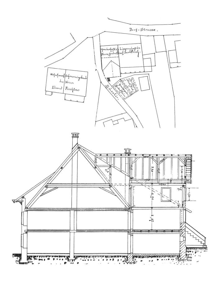
Abb. 7: Situationsplan und Querschnitt (von Westen) von J. Schaffner zum Baugesuch (südliche Erweiterung) von 1914 (Staatsarchiv BL, Liestal).
