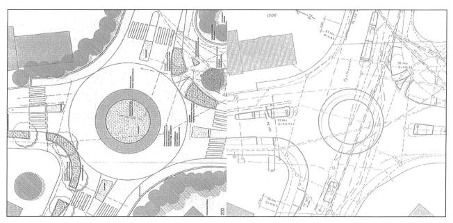
Abbildung 18: Alles dreht sich um Fahrfluss und Sicherheit. Gestaltungsvorschlag und technischer Plan der Kreiselanlage von Kreuzlingen.
