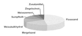
Abb. 9: Die Zusammensetzung des bei den Mauerwerkssanierungen verwendeten Mörtels.
