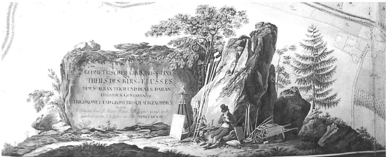
Abb. 8: Ein gemalter «technischer Bericht» über die Vermessung der Birs im Revolutionsjahr 1798, welcher von links nach rechts gelesen den Ablauf der Arbeiten schildert. Im linken Teil – wie eingemeisselt in den Fels, unter welchem ein munterer Bach hervorsprudelt – wird mit dem Titel des Planes angegeben, worum es sich handelt. Im Zentrum steht der Theodolit, an dessen Stativ der Netzplan mit dem Triangulationsnetz anlehnt. Direkt davor liegt die stählerne Messkette, mit welcher die Basis gemessen wurde, rechts darüber stehen einige Stangen und Fähnchen, welche zur Signalisierung der Punkte dienten. An den Fels angelehnt sitzt ein Mann mit Zylinder – laut einer Bleistiftnotiz am unteren Planrand handelt es sich um Professor Daniel Huber –, der Notizen in einem kleinen Buch vornimmt. Rechts neben ihm liegt am Boden eine damalige Tragvorrichtung in Form eines «Felleisens», und daneben ist eine grössere Mappe vermutlich mit den Plänen sichtbar. Am rechten Felsrand sind diejenigen Werkzeuge zu sehen, welche beim eigentlichen Flussbau eingesetzt wurden: Pickel, Schaufeln, Stemmeisen, Körbe und eine Stosskarrette zum Transport der Materialien. Die Länge dieses Ausschnittes beträgt im Original ca. 73 cm.
