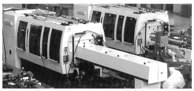
Abb. 14: Ein Drehautomat der neuesten Generation, mit automatischem Stangenwechsel von rechts. Ein aktuelles Produkt der Tornos-Bechler SA Moutier.
