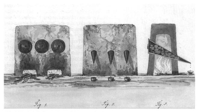
Abb. 6: Ein Asphaltofen aus dem Val de Travers, in Fig. 1 von vorne, in Fig. 2. von hinten und in Fig. 3. im Querschnitt. Der Ofen war etwa 1.5 bis 1.8 m hoch.
