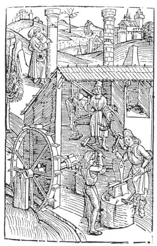
Abb. 4: Schmiede mit Wasserradantrieb des Hammers, 15. Jh. (Quelle: Fietz, Waldemar: Vom Aquädukt zum Staudamm, Leipzig 1966)
