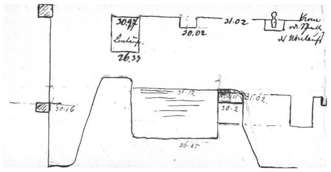
Abb. 5: Querschnitt von M. Bölger für den neuen Kanal, 1839. Um das Gefälle bei den Wasserrädern möglichst gross zu halten, sollte der Kanal an dieser Stelle höher liegen als das Gelände. (Quelle: StA BL, PA 124, 15.)
