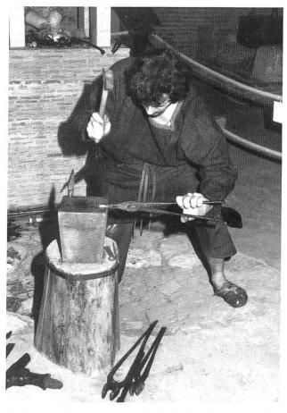
In der neueingerichteten Schmiede der fabrica im Römermuseum Augst bearbeitet der «römische» Schmied H. Ratsdorf am Amboss ein Stück Kanteisen. (Photos: Ursi Schild)
