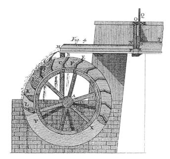
Abb. 5. Oberschlächtiges Wasserrad nach einer Darstellung von Belidor, 1740.
