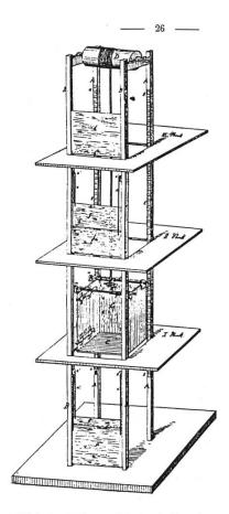
Bild 2. Fahrstuhlmodell mit Schutzvorrichtung, System Nüsperli
