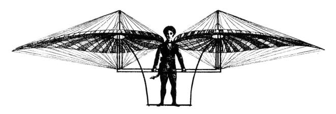
Bild 3. Jakob Degens Schlagflügel-Apparat, konstruiert 1808. Die herzförmigen, mit den Arm- und Beinstangen bewegten Flügel mit je 3500 Klappen, die sich jalousieartig bei der Aufwärtsbewegung öffneten und beim Niederschlag schlossen. Nach einem zeitgenössischen, kolorierten Kupferstich abgebildet in: E. Tilgenkamp, a.a.O., Tafel I.
