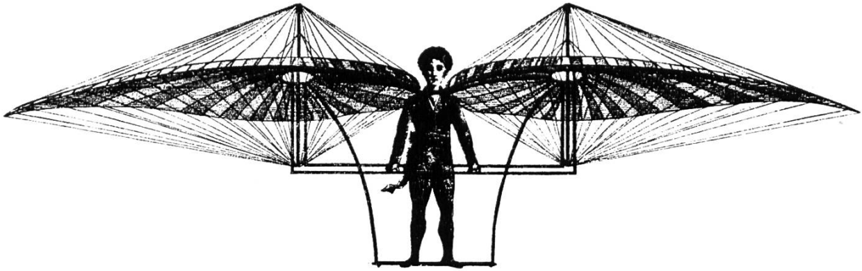
Bild 3. Jakob Degens Schlagflügel-Apparat, konstruiert 1808. Die herzförmigen, mit den Arm- und Beinangen bewegten Flügel mit je 3500 Klappen, die sich jalousieartig bei der Aufwärtsbewegung öffneten und beim Niederschlag schlossen. Nach einem zeitgenössischen, kolorierten Kupferstich abgebildet in: E. Tilgenkamp, a.a.O., Tafel I.
