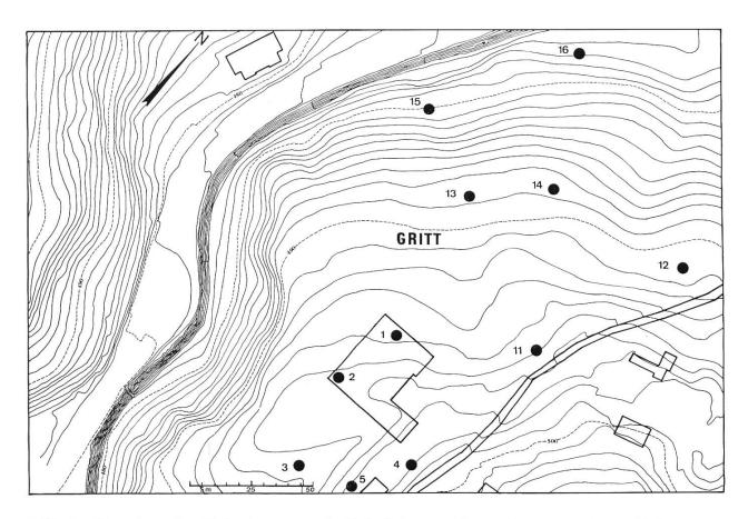
Bild 2. Situation der Ueberbauung mit Lokalisierung der Bohrungen 1973 (Bohrung 5 zirka 15 m weiter unten). Abstand der Höhenkurven 1 m. Aufnahme: Ingenieurbureau Holinger AG, Eintragungen: Dr. W. Mohler. Das Altersheim Gritt im Bereich der Bohrungen 1 und 2.
