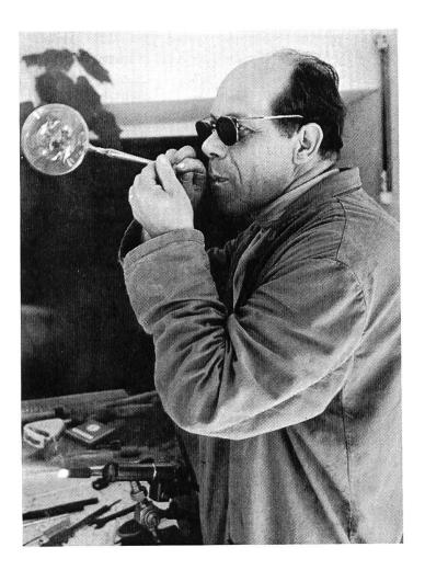
Bild 1. Der entscheidende Augenblick: das flüssig gewordene Glas wird zur Form geblasen. Unten: die Gasflamme.
