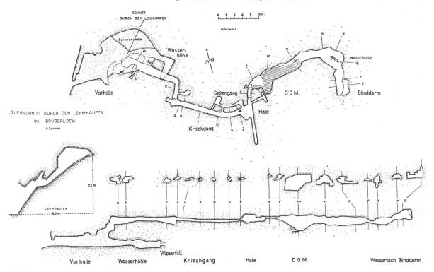
Bild 3. Höhlenplan des Bruderloches. Oben Grundriss, unten Seitenriss mit Querprofilen, unten links Schnitt durch den Lehmhaufen.
