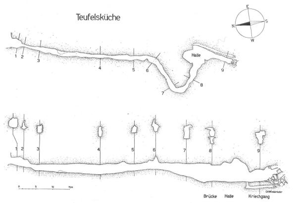
Bild 1. Teufelsküche. Grundriss, Seitenriss mit Querprofilen.
