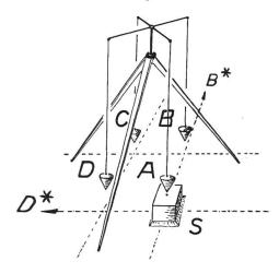
Fig. 11. Die Groma, ein Instrument zum Abstecken rechter Winkel, mit dem die Römer die Welt vermassen, und nach dem sie ihre Vermessungstechniker Gromatiker nannten.
