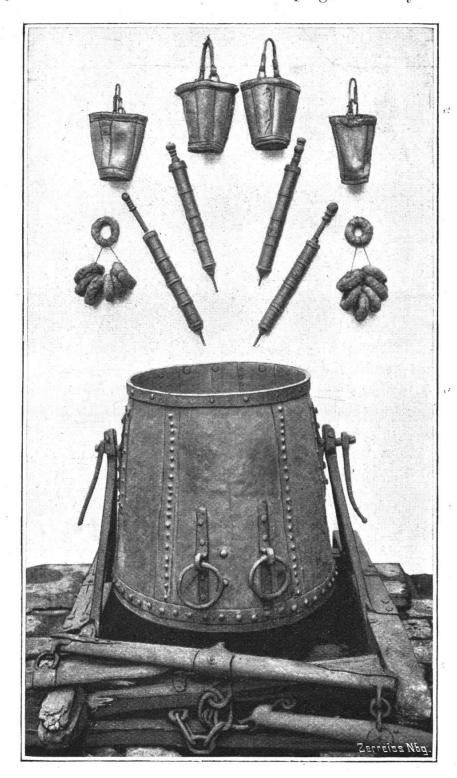
Fig. 2. Nürnberger Löschgeräte: Kupferne Wasserkufe, 300 Liter fassend, auf Schleife; messingene Handfeuerspritzen 1499 und 1544; Ledereimer; Harzringe zur Beleuchtung des Brandplatzes.
