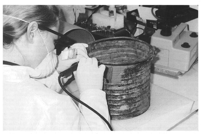
Nel laboratorio viene usato per i lavori molto delicati lo scalpello a ultrasuoni
